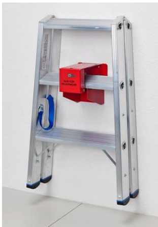
Beispiel einer möglichen Leitersicherung
